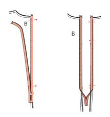
Montez la fermeture éclair invisible : posez la couture MDS de B et la fermeture éclair devant vous, avec l'endroit vers vous. Posez le ruban gauche de la fermeture éclair sur la couture MDS du dos à gauche devant vous, endroit sur endroit. Le ruban de la fermeture éclair est aligné avec le bord du tissu. Les dents commencent à
