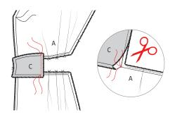
Épinglez le côté court droit de l'empiècement de la taille (C) du devant sur la couture verticale de la découpe de la taille de A, endroit sur endroit et faufils sur faufils (C est posé vers la couture MDV avec le bord courbe vers le haut). Piquez entre les faufils. Pliez la couture de C de côté et donnez un cran en biais dans les coins de A jusqu'au faufil.
