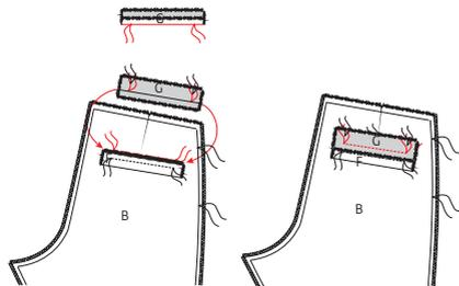
Pliez et repassez le long côté de G avec les faufils 1 cm sur l'envers et rouvrez. Posez G sur B, l'endroit vers le bas. Les faufils de G correspondent exactement aux faufils supérieurs de B. Piquez dans la ligne de pli repassée entre les faufils. Il restera 1,5 cm des deux côtés.
