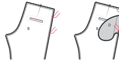
Réalisez une surpique décorative au-dessus de la poche. Épinglez le côté droit de D/E sur B, endroit sur endroit et faufils sur faufils. Piquez entre les faufils.
